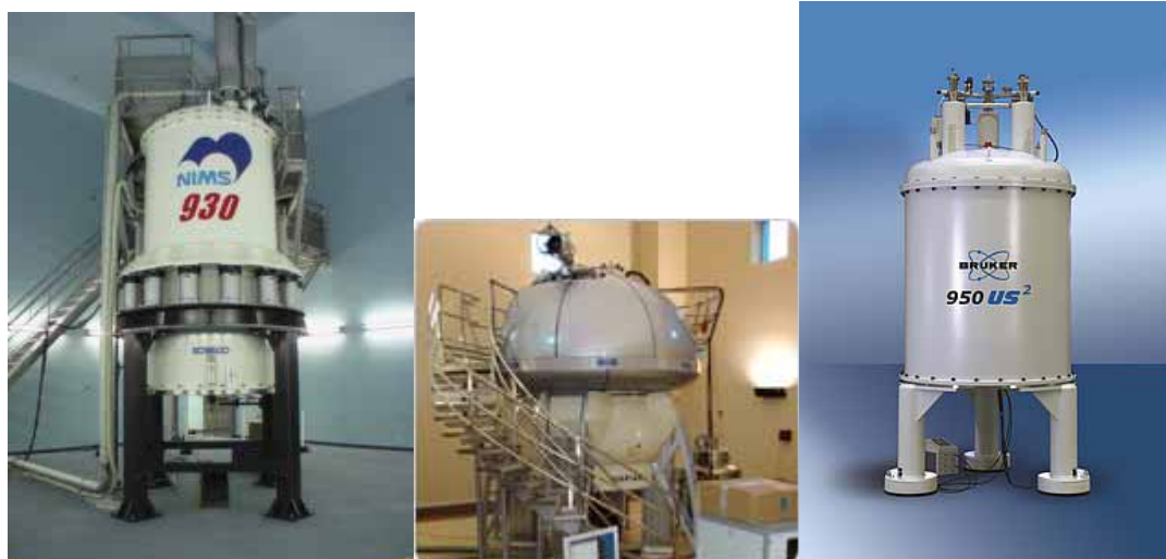
図1 最高磁場クラスのNMRマグネット 左：930MHz NMR（NIMSと神戸製鋼所）中：Oxford社の950MHz NMRマグネット、右：Bruker Biospin社の950MHz NMRマグネット
