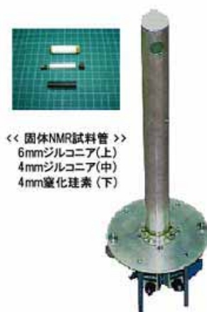
図 4 固体高分解能NMRプローブ
